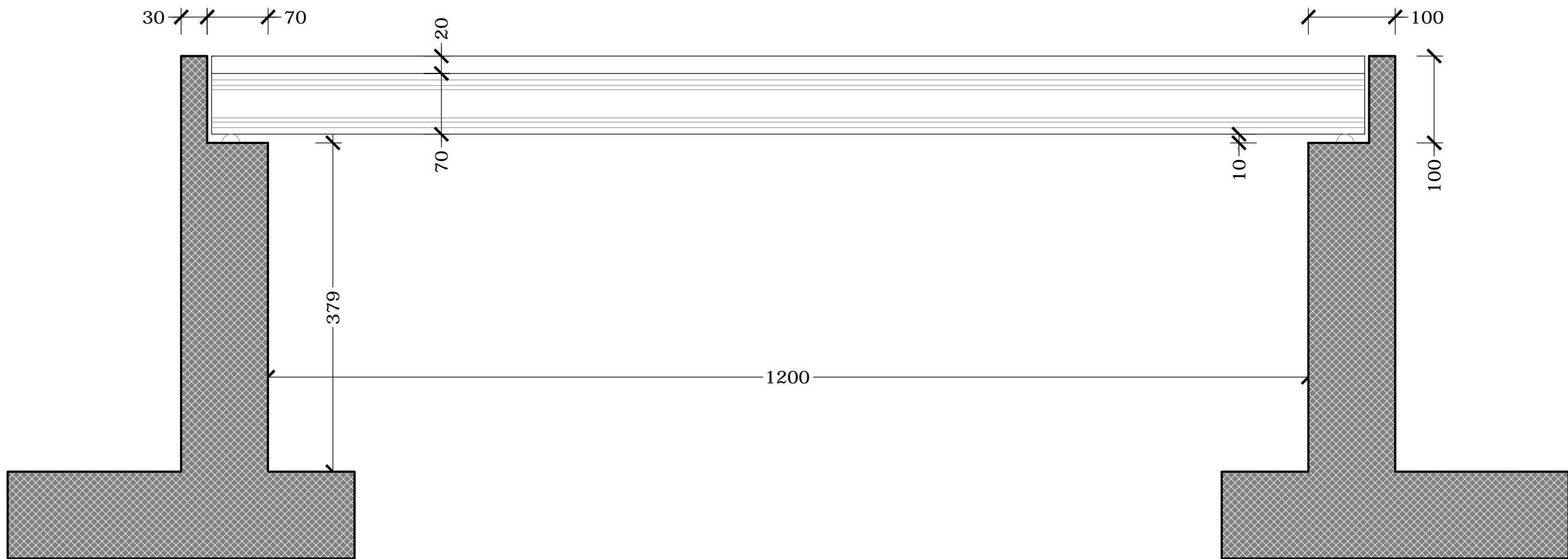
Sezione Tombino Idraulico
